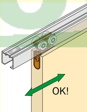
ソフトクローズ機能が万が一誤作動しても、扉を一度開け閉めするだけで自動的に正常位置に復帰する、自動復帰機能を標準装備しています。
