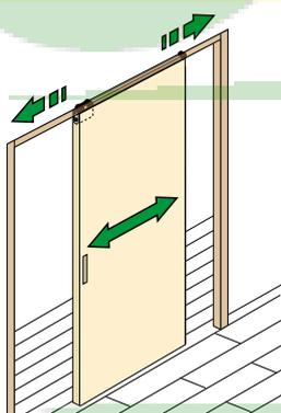
1つのローラーに双方方向のクローザー機能を付けることで、扉の動きを左右で制御します。閉じる側、開く側どちらも、軽くなめらかな動きを実現しています。
