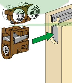
木口に取り付けた専用ケースカバーに、上ローラーを押し込むだけで簡単に扉を取り付けることができます。装着時に工具は一切不要です。
